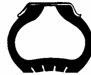
Falta de pressão
