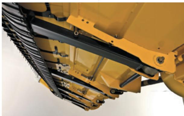
A pressão sobre o solo da barra de corte é controlada e mantida através de um bloco de torção totalmente ajustável, que está localizado entre a armação principal e o braço de apoio.
